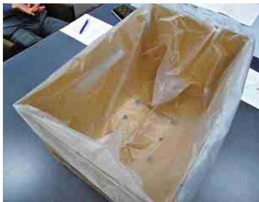
急速凍結のための工夫(穴あき箱)
