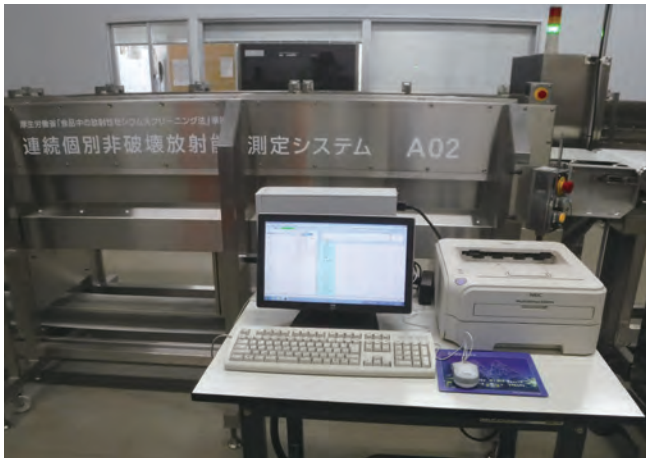
連続個別非破壊放射能測定システム
